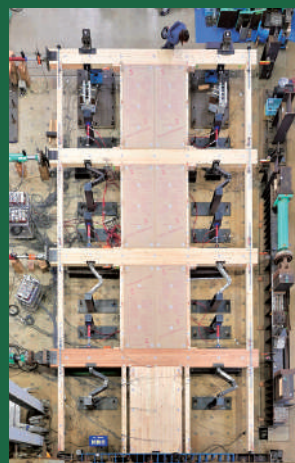
下階CLT、上階枠組壁工法の実験
