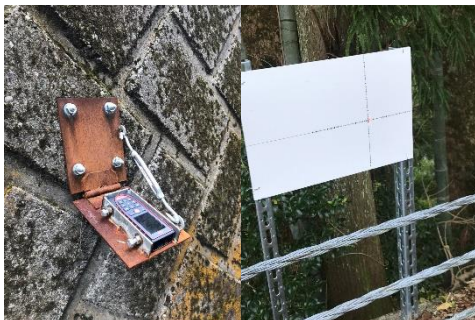
写真-6 簡易かつ定量的な計測のための計測機器、(a) レーザー距離計、(b) 照射板
