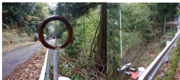
見通し棒 (一直線に配置した棒を定点から見通す)
