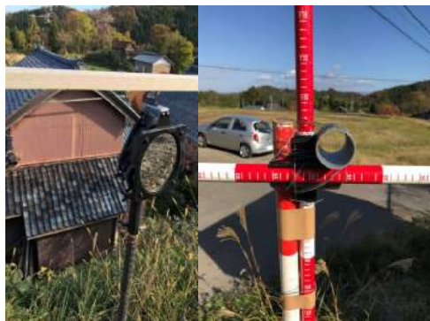
SOP (鏡を用いて斜面の動きを監視)
